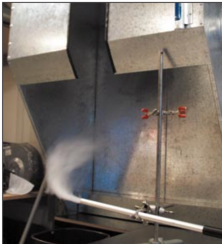
Selv om tornadoen får skåret en bred revne i skærmen foran, så der bliver plads til en kran, suger den fortrinligt (foto: Bjarne Pless).
