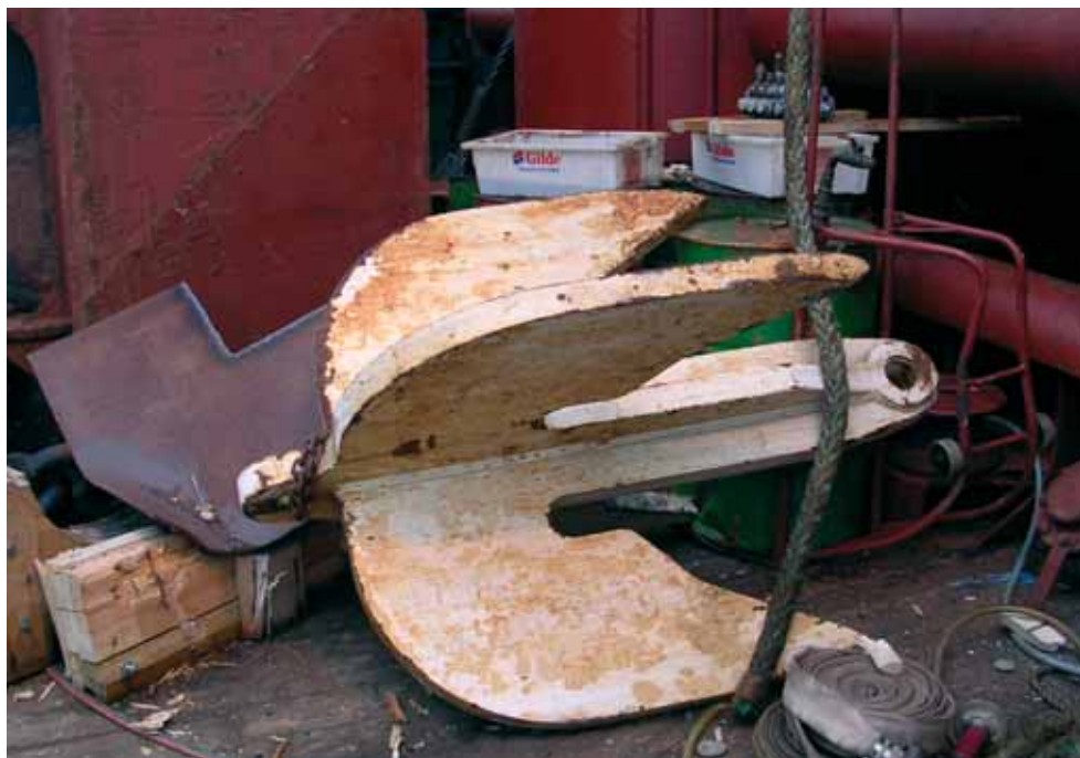
Near miss er en situation, hvor det kunne være gået galt; hvis man tilfældigvis ikke lige var meget heldig. Denne krankrog faldt ned på et skibsdæk under løft af container til en olierig. Ingen blev ramt. Altså var der tale om et near miss.
