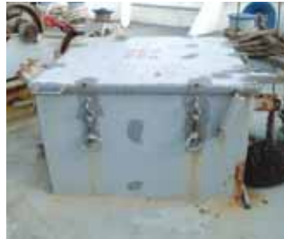
Lugekanten er 75 cm høj, så det er besværligt at komme ud og over den. Uden et solidt greb i lugen.
