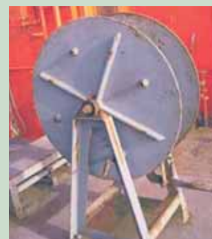
Stiverne på tromlen udgjorde sammen med stativet en farlig cocktail, der kostede en filipinsk motormand det yderste led på venstre ringfinger.
