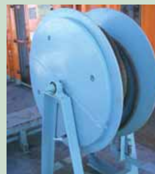
Tromlens konstruktion er ændret, og stiverne er afskærmet, så det nu ikke længere er muligt, at få fingrene i klemme mellem stativet og tromlen.
