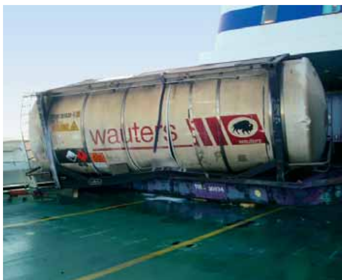
En af de nearmiss rapporter, DFDS har modtaget, handlede om en tank, der rev sig løs i hårdt vejr og anrettede omfattende skader på skibet. Foto: DFDS.
