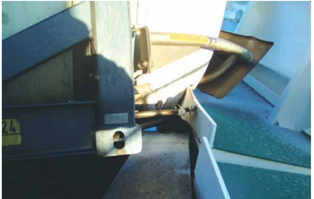
Der gik hul på tanken, og methylamin strømmede ud, men heldigvis skete der ingen skade. Foto: DFDS.
