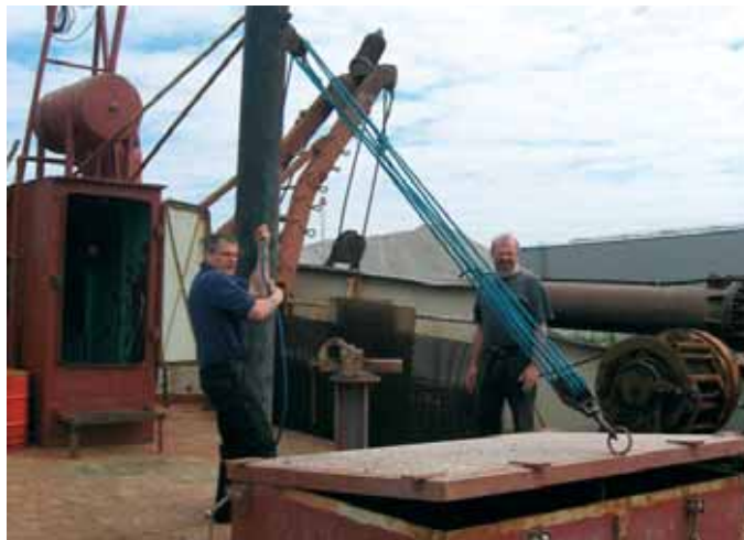
En talje har lettet arbejdet og gjort det mindre risikabelt at åbne lugen.
