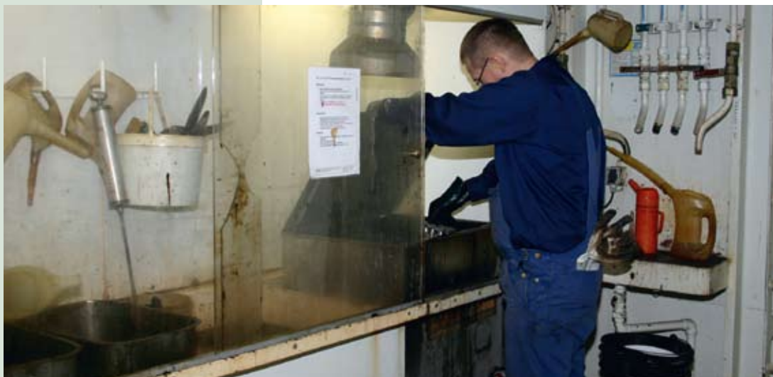
Rensning ved hjælp af ultralyd sparer kemikalier og forebygger, at medarbejderne i maskinen udsættes for unødige påvirkninger.
