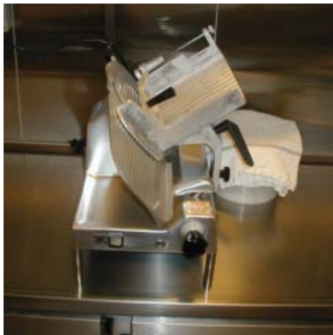
Eksempel 4: Pålægsmaskine med restholder. Der er monteret en afbryder, som forhindrer maskinen i at køre, når afskærmningen er fjernet.
