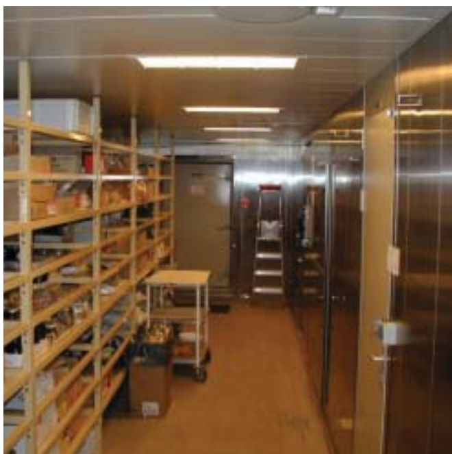
Eksempel 7: Proviantrum indrettet med tremmehylder. De tungeste ting er placeret nederst. Der er desuden et rullebord, som kan lette transportarbejdet.
