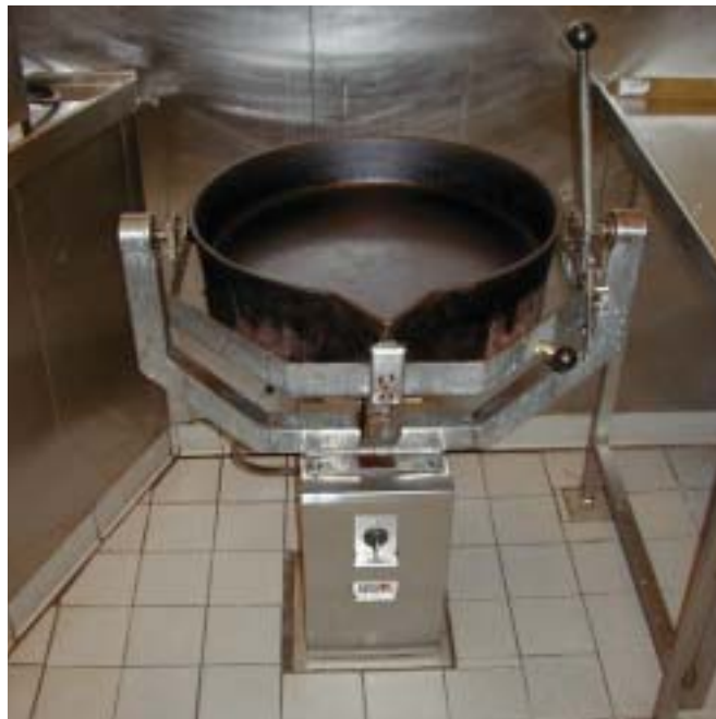
Eksempel 2: Kardansk ophængt kipsteger. Kipstegeren kan fastlåses i 5 positioner.
