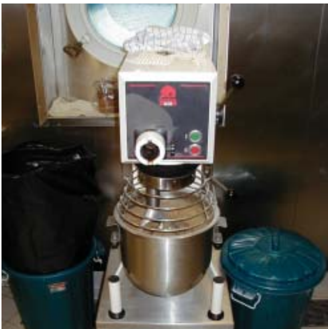
Eksempel 3: Røremaskine med sikkerhedsskærm og automatisk afbryder, der sikrer, at maskinen stopper, når skærmen løftes. Røremaskinen er hævet, så der opnås god arbejdsstilling.
